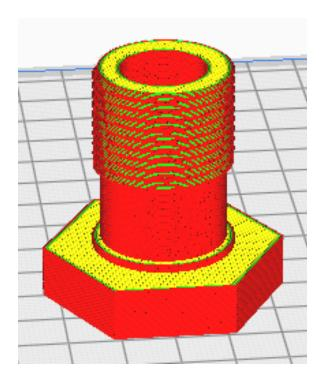
Klemmteile konnte man bisher schon als STL-Dateien generieren und drucken. Jetzt ist das auch für Schraube und Mutter möglich. So kann man ein Modell der Schraubenverbindung mit 3D Drucker erstellen. Interessant ist das vor allem bei Sonderschrauben.
