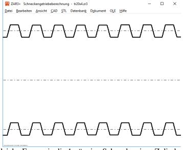
Ein Gewinde hat die gleiche Form wie die 1-gängige Schnecke eines Zylinderschneckengetriebes. Die Form der Zylinderschnecke ist wiederum gleich wie ein schrägverzahntes Stirnrad mit Zähnezahl 1 und großem Schrägungswinkel. Die Abmessungen einer Trapezgewindespindel kann man als Schnecke in ZAR3+ berechnen. Der Keilwinkel eines Trapezgewindes ist 30°, dann ist der Eingriffswinkel der Schnecke 15°.
