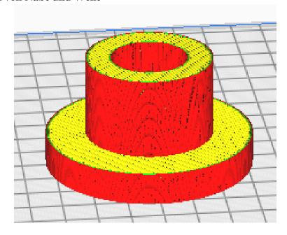
Ein Modell von Welle und Nabe kann man jetzt auf dem 3D-Drucker herstellen. Nur als Anschauungsobjekt, die Presspassung kann natürlich mit dem 3D Drucker nicht in der geforderten Genauigkeit und Oberflächengüte hergestellt werden.
