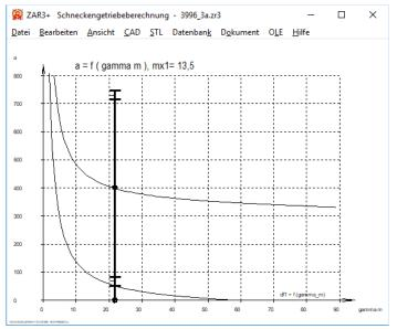
In das Diagramm mit dem Achsabstand als Funktion des Schrägungswinkel werden Teilkreisdurchmesser, Kopf- und Fußkreisdurchmesser von Schnecke und Schneckenrad eingezeichnet. Eine zusätzliche Kurve gibt es für den Fußkreisdurchmesser der Schnecke. So kann man abschätzen, welcher Schrägungswinkel für einen hohen Wirkungsgrad und einen bestimmten Achsabstand machbar ist, ohne daß der Kerndurchmesser der Schnecke zu dünn wird.
