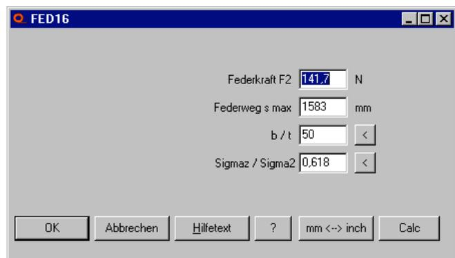
Bei Eingabe der Abmessungen berechnet FED16 Federkraft, Auszuglänge, Spannung und Lebensdauer.
