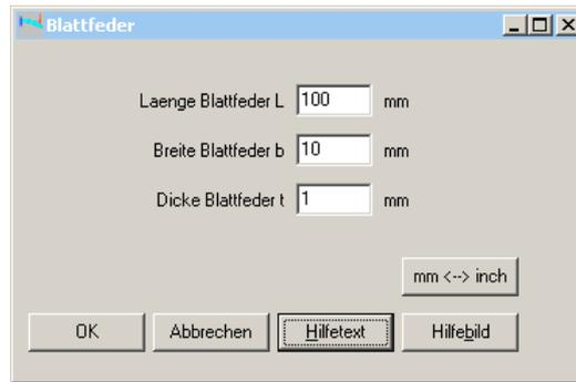
Wenn die Blattfeder einfach nur ein Stück Federband ist (wie in FED15), gibt es jetzt eine vereinfachte Eingabe für Breite, Dicke und Länge der Wellfeder. Diese kann man unter "Bearbeiten -> Berechnungsmethode" konfigurieren.
